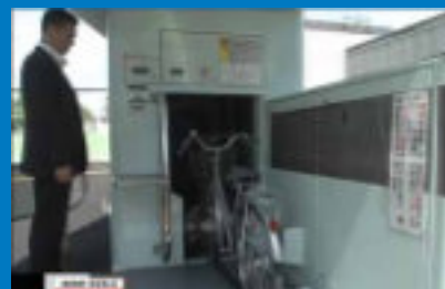
Het automatisch afleveren van de fiets vergt ongeveer 17 seconden per fiets.
