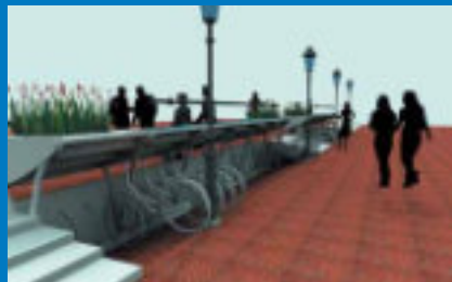
Deze fietsenstalling bestaat uit een afwisseling van langgerekte banken, lage trapjes naar het plein, plantenbakken en verlichtingsarmaturen. De fietsenstalling wordt door de banken verborgen voor het plein. Thijs van Oostveen
