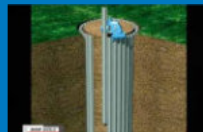
Deze trommel wordt opgebouwd uit damwanden...
